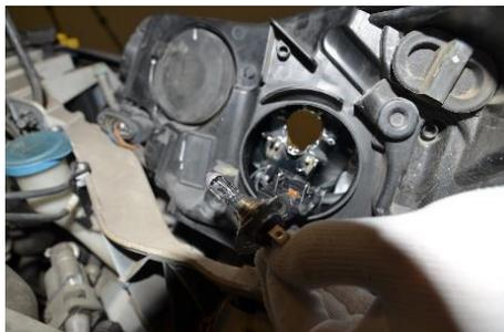
1. Снимите заднюю крышку и оригинальную лампу.
