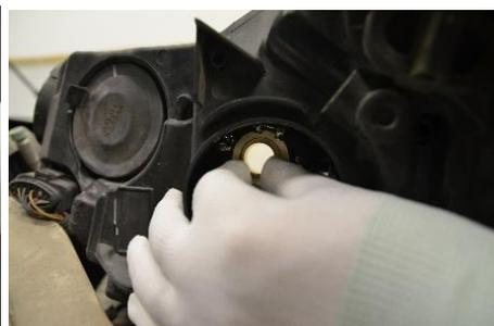
3. Закрепить пряжки и стопорное кольцо вместе внутри лампы светильника.
