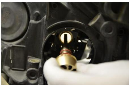
4. Вставьте светодиодную лампу OSRAM в приспособление и найдите подходящее место.
