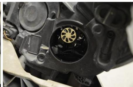
6. Отрегулируйте тип освещения для лучшего эффекта, поверните заднюю крышку и плотно закройте.
